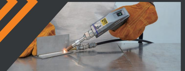
El sistema de soldadura láser proporciona un control constante de la frecuencia de oscilación y el ancho de soldadura que puede llegar a 4,0 mm (0,16"), lo que proporciona costuras de alta calidad constante, sin necesidad de trabajos adicionales.
